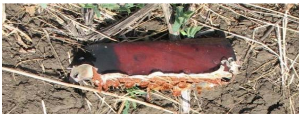
Рис. 2. Вид фрагментов обшивки (а, б) и законцовки (в) лопасти № Г-1296 (монтажный № 1) рулевого винта, обнаруженных на расстоянии 2300 метров от места падения вертолета
